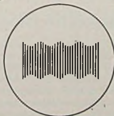
Fig. 13. Correct SSB-sig-naal met goede draaggolf- en zijband-onderdrukking.
